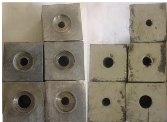
Figura 4. Colimadores preparados no CTEEx.
