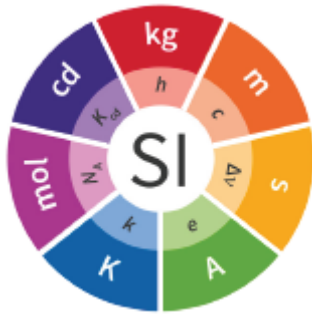
Figura 1 SI Illustration Representação gráfica do SI incluindo as unidades de medida e as correspondentes constantes fundamentais que as definem [3].
