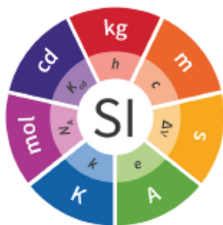
Figure 1 SI Illustration Representação gráfica do SI incluindo as unidades de medida e as correspondentes constantes fundamentais que as definem [3].
