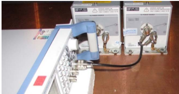
Figura 3. Conexão entre o gerador e o LISN do laboratório SENAI CIMATEC.
