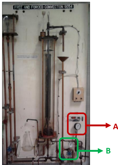
Figura 1. Banco de convección libre y forzada
