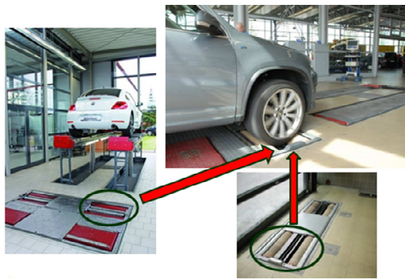
Figura 1 Localização do frenômetro em uma linha de inspeção de segurança veicular.
