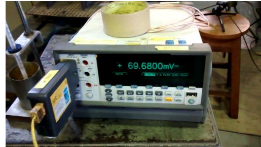
Figura 1. Detalhe do resultado errôneo do sistema devido à interferência.
