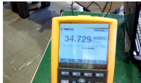
Figura 2. Detalhe do resultado correto de um equipamento submetido à interferência, porém imune a ela.
