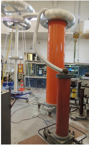
Fig. 3. Comparación en alta tensión entre el capacitor viajero y uno similar de 200 kV perteneciente a UTE.
