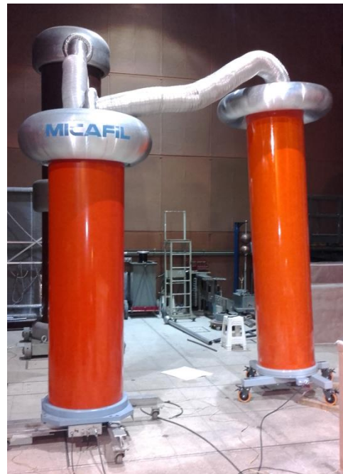
Fig. 2. Comparación en alta tensión entre el capacitor viajero y uno similar de 600 kV perteneciente a INTI.
