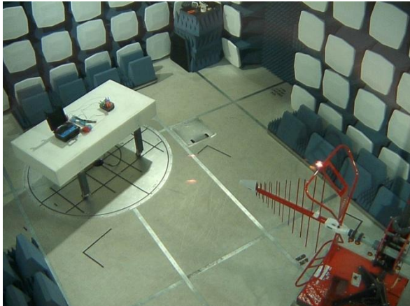
Figura 2. Setup de medição conforme a norma CISPR 11.
