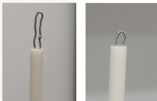
Figura 2a – Detalhe da região de solda dos fios e Figura 2b - Posterior inserção no capilar.
