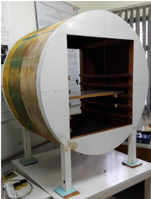
Figura 1: Bobina geradora de campo ( B_{\text{máximo}} = 10 \text{ G} ).
