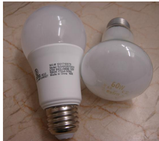
Figura 2 – Lâmpadas Equivalentes – Led, Amostra A06 e Incandescente.
